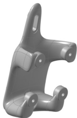
Obrázek 57 Optimalizovaný držák motoru PA12 – pro variantu č. 6
