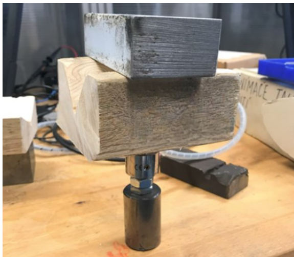
Obrázek 28 Kalibrace snímače tlaku
