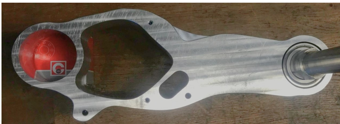
Obrázek 62 Samotný tvar ramene bez výztuh
