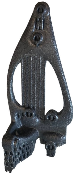
Obrázek 67 Vytisknutý díl s podporami
