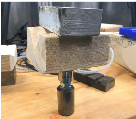
Obrázek 28 Kalibrace snímače tlaku
