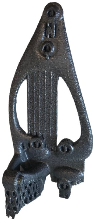
Obrázek 67 Vytisknutý díl s podporami
