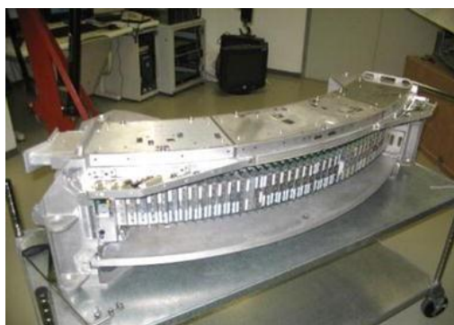
Obrázek 11: Systém detektorů s 42 moduly od společnosti Philips https://link.springer.com/article/10.1007/s40134-012-0006-4#Fig3
