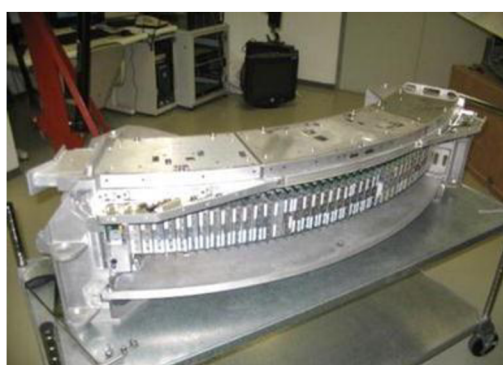
Obrázek 11: Systém detektorů s 42 moduly od společnosti Philips https://link.springer.com/article/10.1007/s40134-012-0006-4#Fig3
