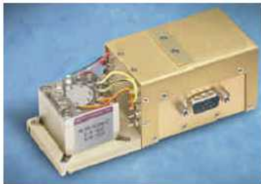
Obr. 23: YIG oscilátor MLXS-0218SD (převzato z [17])
