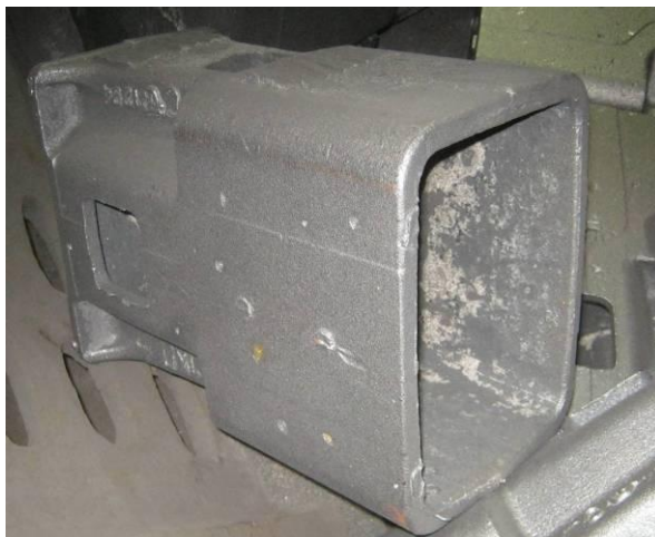
Obr.7.9 , 7.10 Výskyt zadrženin a připečenin uvnitř odlitku nárazníku
