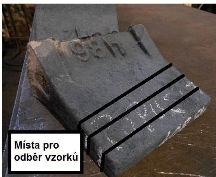
Obr. 3.1 Schéma míst pro odběr vzorků z přilitého bloku (viz kapitola 1)
