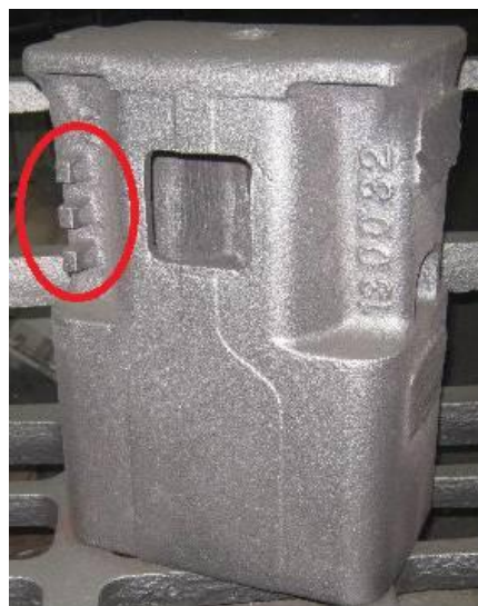
Obr. 1.4 Tělíska pro vyhodnocení lomových ploch
