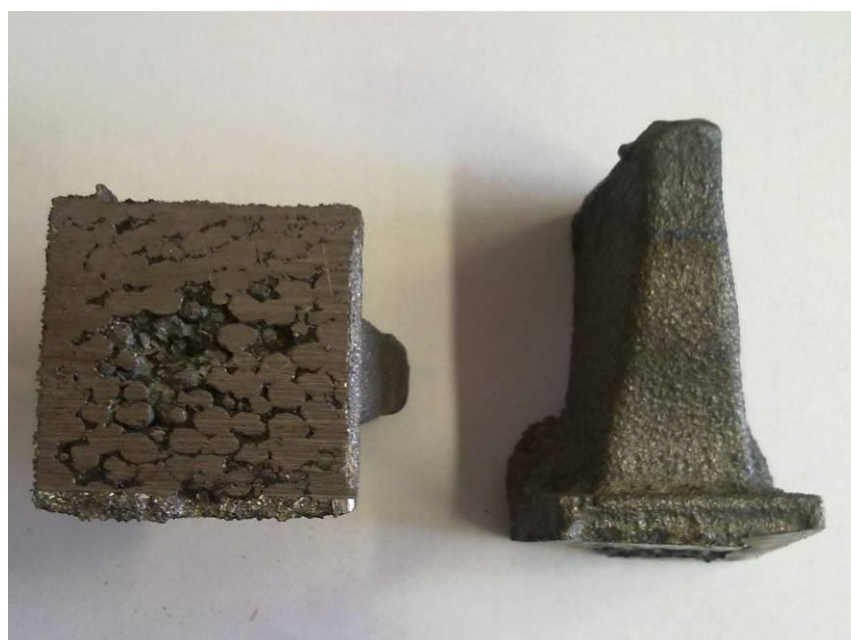
Obr. 7.5 Řez B ucpaným filtrem
