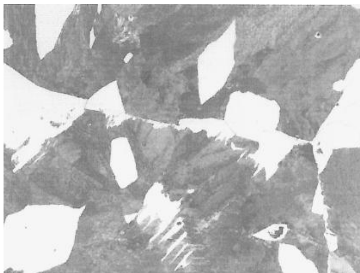
Obr. 9.3 Struktura nárazníků před tepelným zpracováním (bílá fáze ferit, tmavá fáze perlit) – zvětšení 500x
