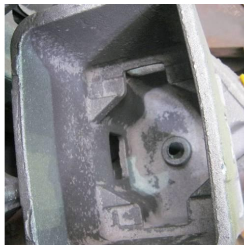
Obr.7.9 , 7.10 Výskyt zadrženin a připečenin uvnitř odlitku nárazníku
