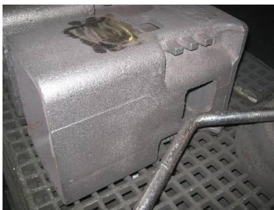
Obr. 7.11, 7.12 Odlitky nárazníků odlévané přes filtr
