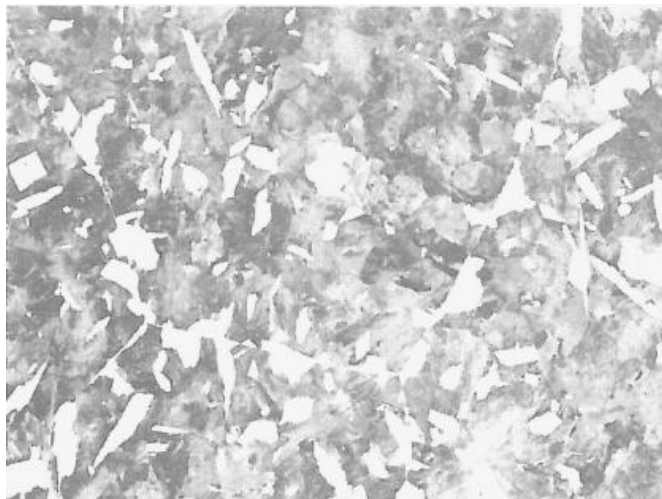
Obr. 9.2 Struktura nárazníků před tepelným zpracováním (bílá fáze ferit, tmavá fáze perlit) – zvětšení 100x
