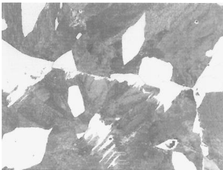
Obr. 9.3 Struktura nárazníků před tepelným zpracováním (bílá fáze ferit, tmavá fáze perlit) – zvětšení 500x
