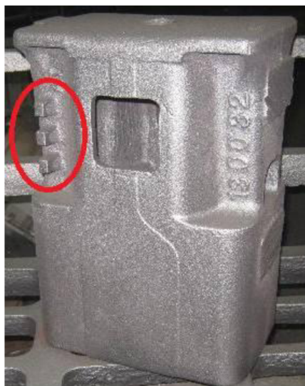
Obr. 1.4 Tělíska pro vyhodnocení lomových ploch
