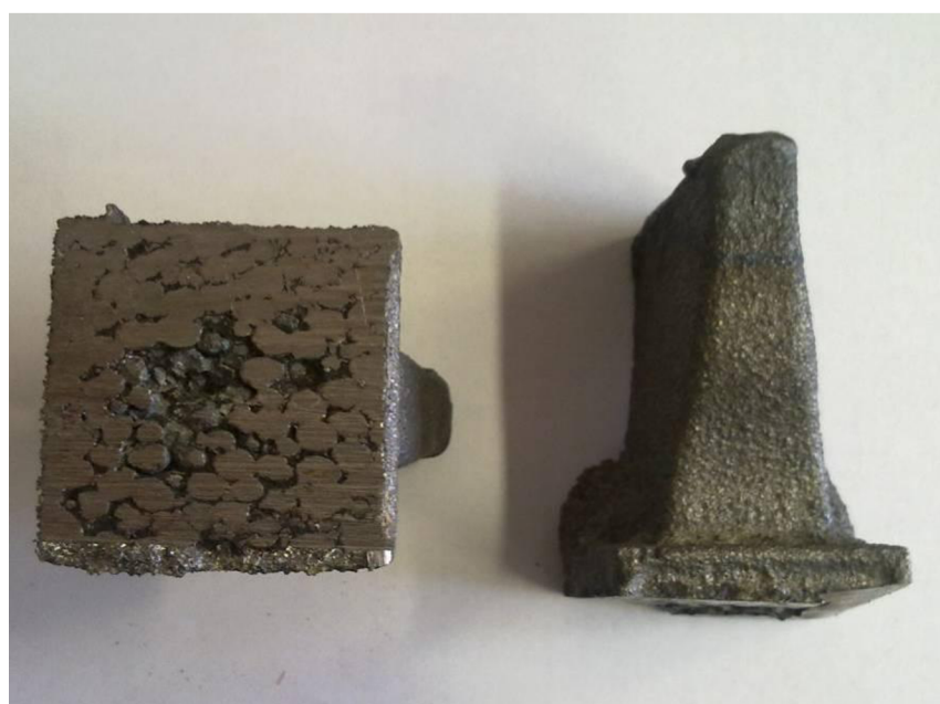
Obr. 7.5 Řez B ucpaným filtrem
