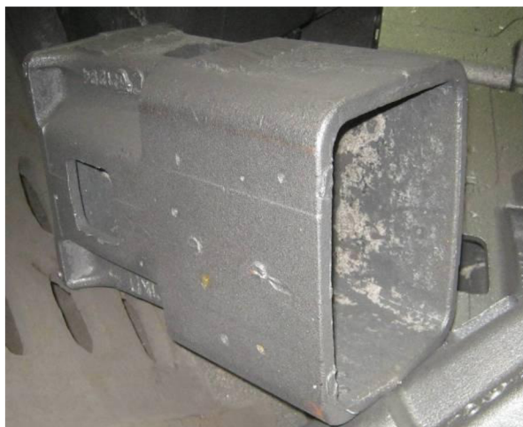
Obr.7.9 , 7.10 Výskyt zadrobenin a připečenin uvnitř odlitku nárazníku
