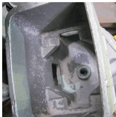
Obr.7.9 , 7.10 Výskyt zadrobenin a připečenin uvnitř odlitku nárazníku
