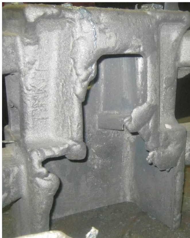
Obr. 7.3 Nedolitý kus nárazníku
