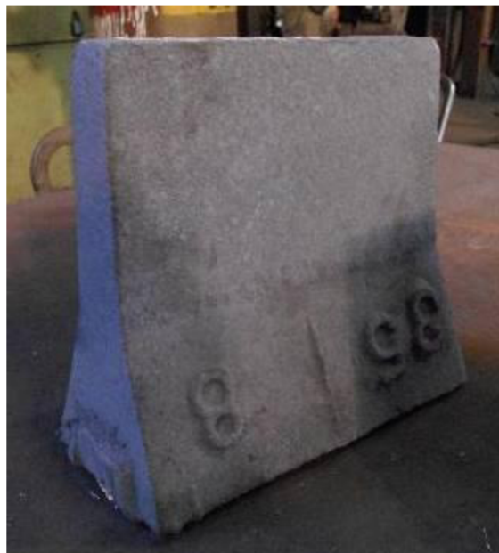
Obr. 1.2 Přilítý zkušební blok
