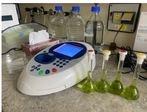
Obrázek č. 28 – Přístroj pro spektrofotometrické stanovení chlorofylů a karotenoidů
