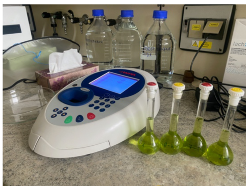
Obrázek č. 28 – Přístroj pro spektrofotometrické stanovení chlorofylů a karotenoidů
