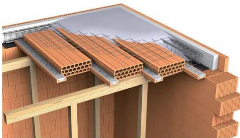
Obrázek 24 - betonáž keramického stropu (4)
