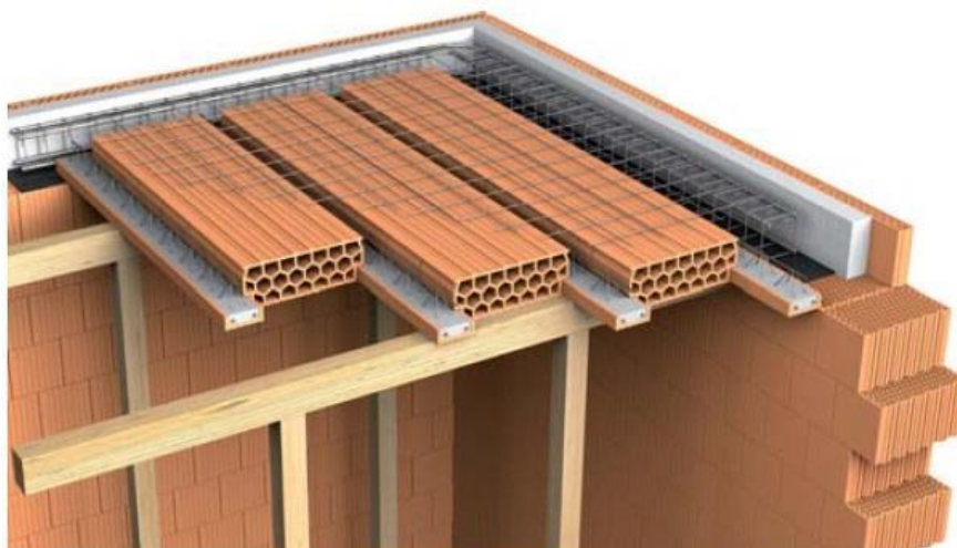
Obrázek 23 - uložení vložek na keramické nosníky (4)
