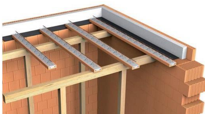
Obrázek 21 - ukládání stropních nosníků (4)
