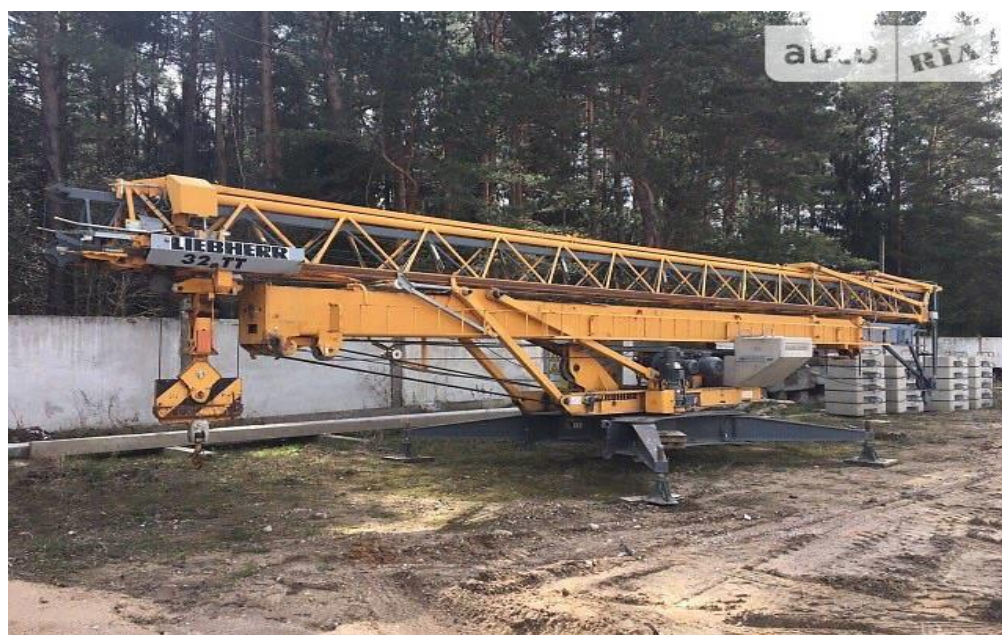
Obrázek 30 - věžový jeřáb 32H (6)
