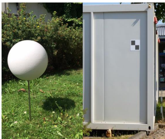
Obr. 7 Príklad vlicovacích bodov- guľa a terč [36]
