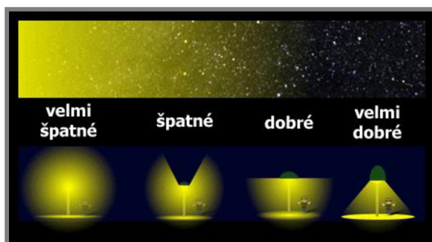
Obr. 2.1 Volba konstrukce lamp [17]
