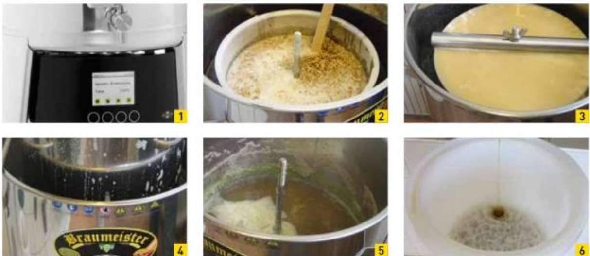
Obrázek 11: Vizuální zobrazení procesu vaření technologií Braumeister, Zdroj: https://www.speidels-braumeister.de/en/home.html
