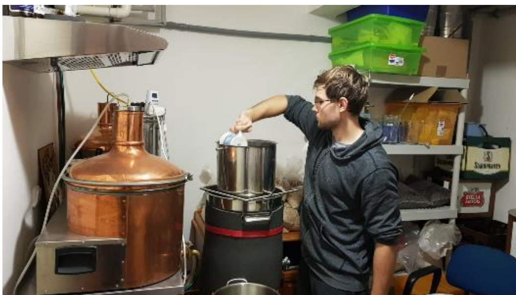
Obrázek 6: Zařízení Braumeister – vyslazování, v popředí hrnec s vyslazovací vodou ohřátou na 78 °C, Zdroj: archiv autora
