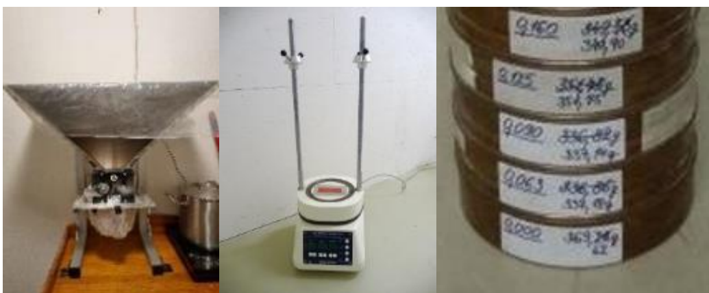
Obrázek 4: Zleva: Mlýnek značky mattmill na šrotování sladu, Přístroj na měření, Síta, Zdroj: Zleva archiv autora, archiv L. Chládky
