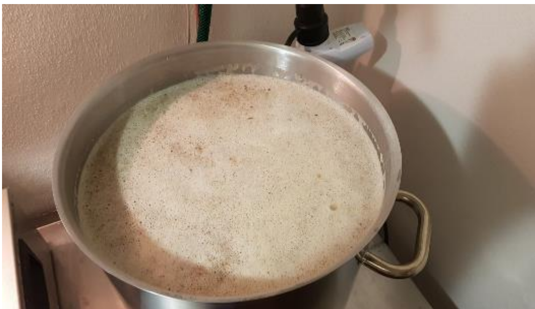
Obrázek 5: Zařízení BrauEule II Pro vystírací kád' po odrumtování před vyslazováním, Zdroj: archiv autora
