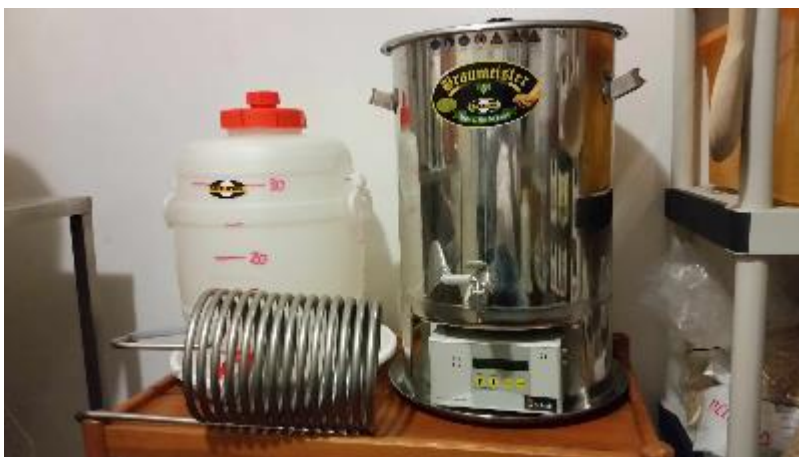
Obrázek 15: Braumeister s chladicí spirálou a kvasnou kádí, Zdroj: archiv autora
