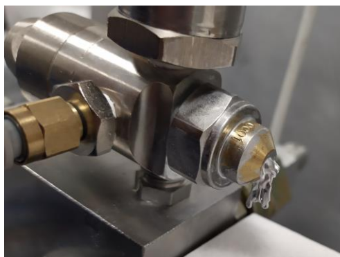
Obr. 4-4 Okap na koncovce s větším vnitřním objemem
