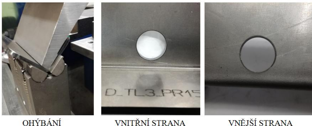
Obr. 117 Ohyb vzorku TE_4 na ROLLBENDu
