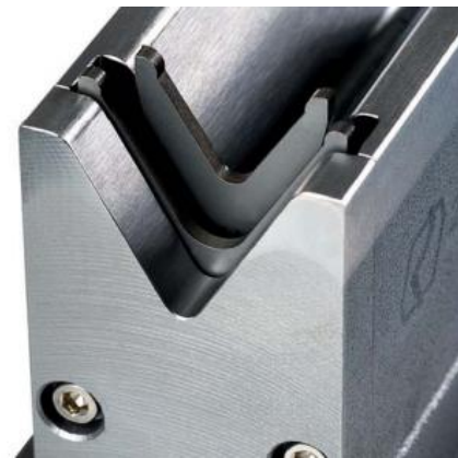
Obr. 58 Mechanické snímání úhlu v matrici [35]
