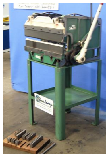
Obr. 50 Ruční ohraňovací lis [43]
