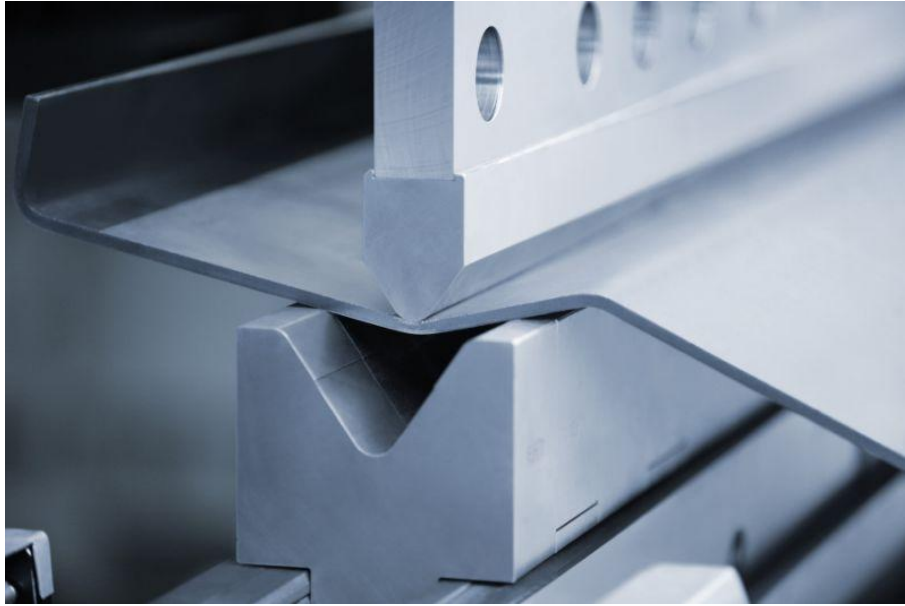
Obr. 16 Ohyb na ohraňovacím lisu [23]
