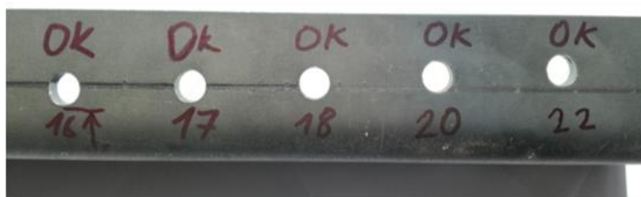
Obr. 70 Nezdeformované otvory počátečním návrhu
