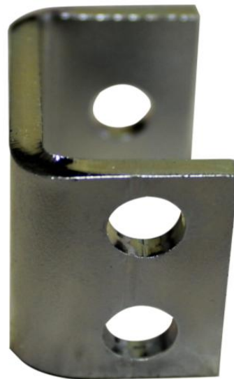
Obr. 3 Výrobek s nedeformovanými otvory
