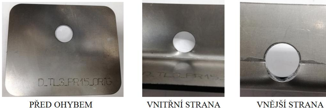
Obr. 110 Originální vzorek TE_3 před a po ohybu
