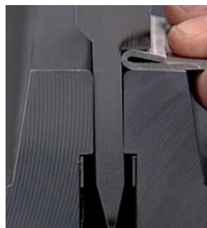
Obr. 36 Ohyb s přeložením [35]
