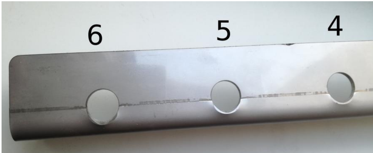
Obr. 102 Tři nejvíce deformované otvory ve skutečném Vzorku 24
