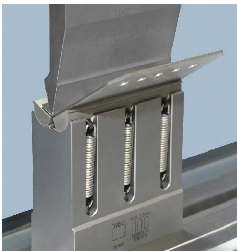
Obr. 43 Ohyb na ROLLBEND [38]
