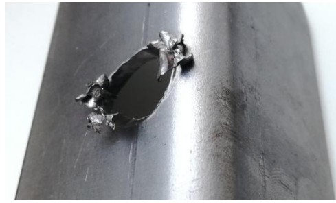
Obr. 114 Otvor v TE_1 po vrtání
