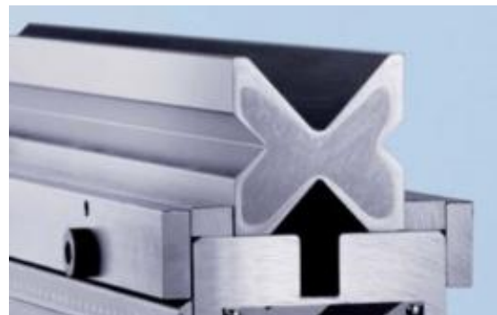
Obr. 48 Upnutí pomocí svorek [35]
