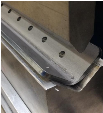
Obr. 86 Razník v poloze po ohybu
