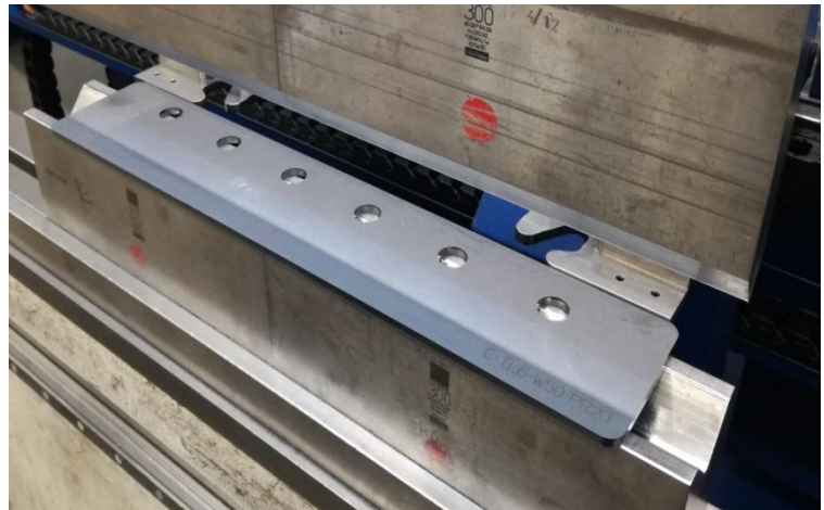
Obr. 84 Založení a dorazená vzorku
