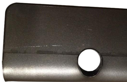
Obr. 4 Deformace otvoru v blízkosti
