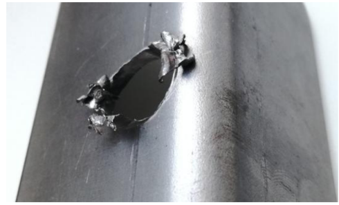
Obr. 114 Otvor v TE_1 po vrtání
