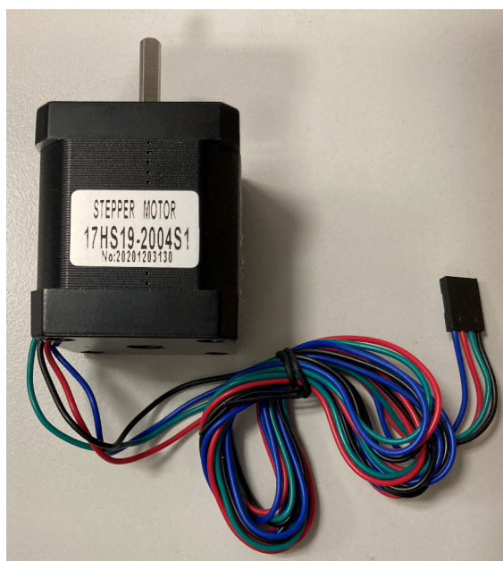
Obr. 3.1: Krokový motor 17HS19-2004S1
