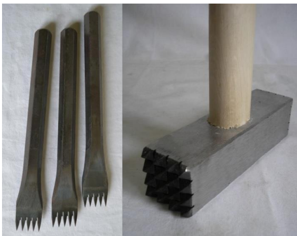
Obr.18– ukázka kamenických nástrojů – vlevo zubák, vpravo pemrlice (zdroj: weha.cz [online])
