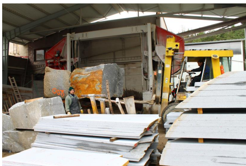
Obr. 11 – příprava bloku žuly k řezání na lanové pile, v popředí nařezaná deskovina (zdroj: autor)
