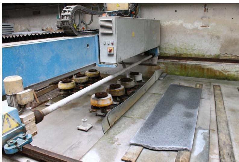
Obr. 12 – leštění žulové desky (zdroj: autor)
