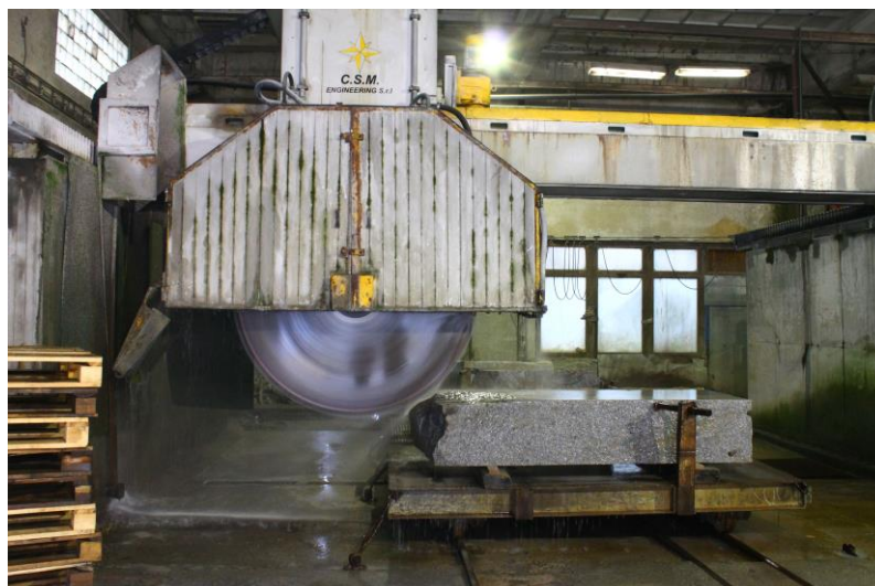
Obr. 19 - řezání žulového bloku kotoučovou pilou (zdroj: autor)
