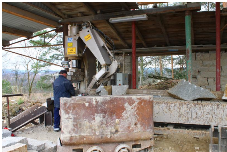
Obr. 17 - proces štípání, vlevo dole jsou již hotové plátky (zdroj: autor)
