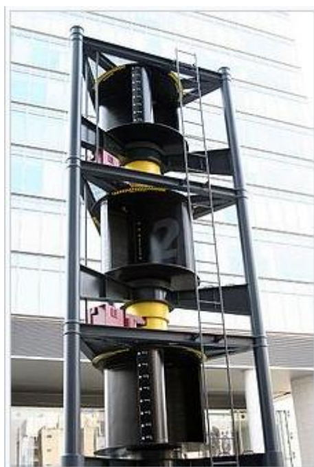
Obr. č. 2 Typ rotoru Savonius
