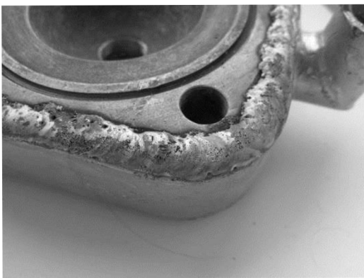
Obr. 2.5 Ukázka pórovitosti ve svaru [25]
