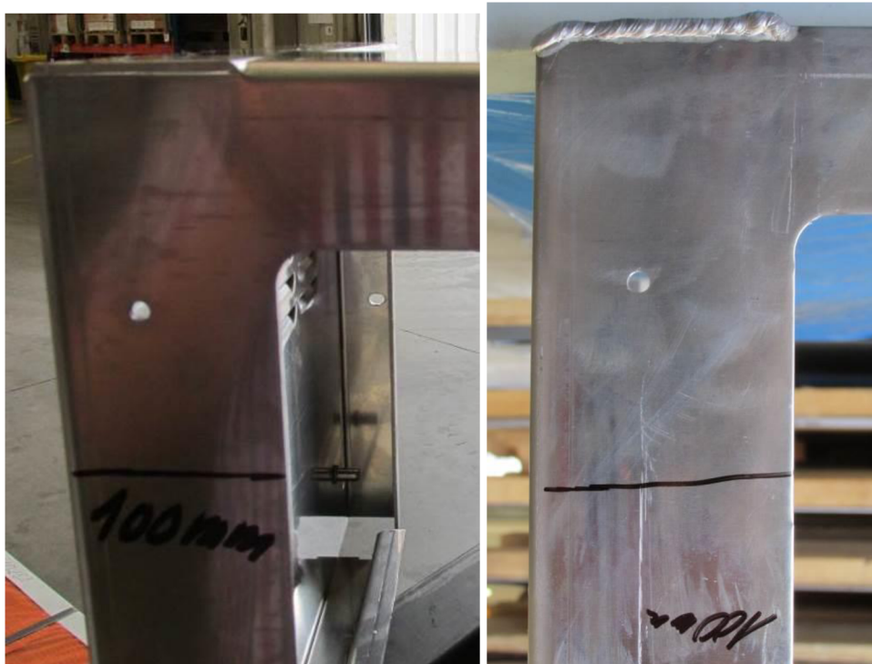
Obr. 8. 20 Fotografie s rozvržením měřené oblasti a po zavaření vzorku
