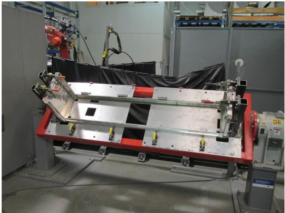
Obr. 8. 13 Fotografie upnutého svařovacího přípravku na svařovacím pracovišti
