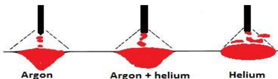
Obr. 3.7 Vliv ochranného plynu na hloubku závaru [20]
