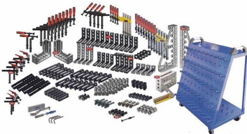
Obr. 8. 4 Modulární upínací prvky pro 3D svařovací stoly [4]
