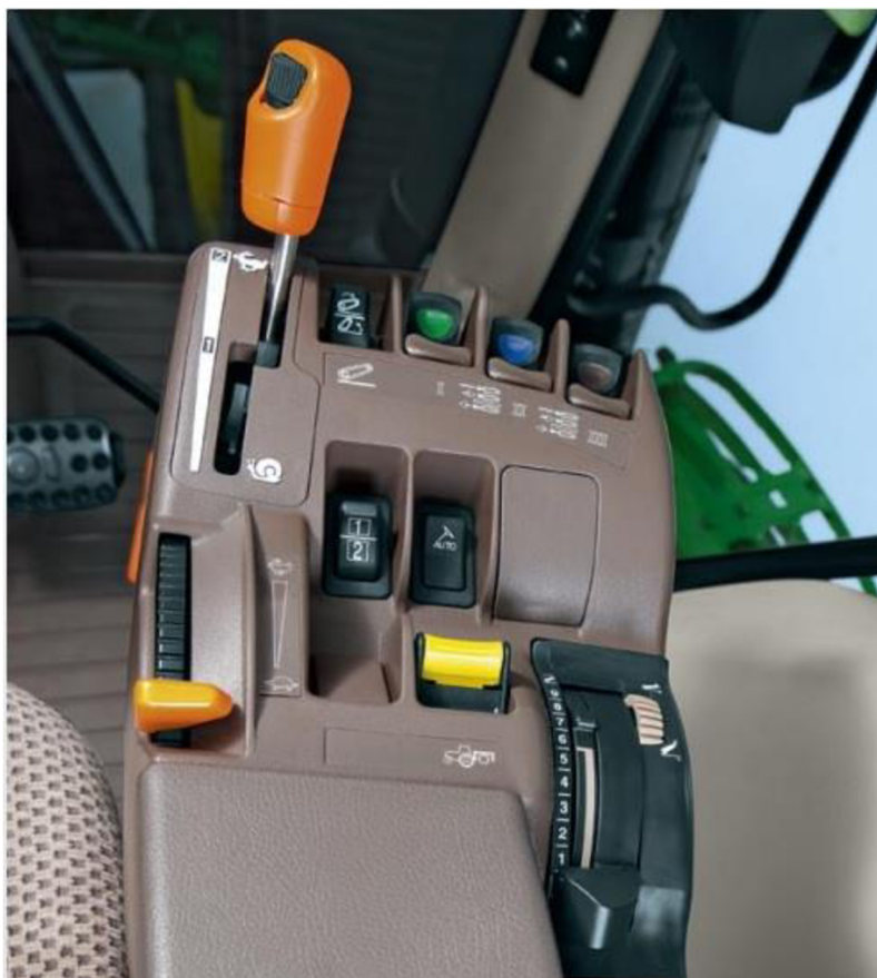
Obrázek 1.2: Ovládání převodovky Autopowr (Lukrom.cz, 2021)
