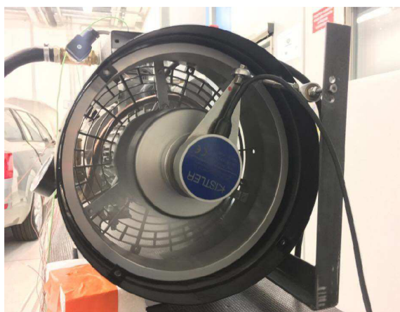
Obrázok 4.2: Zapojenie snímača otáčok Kistler.
