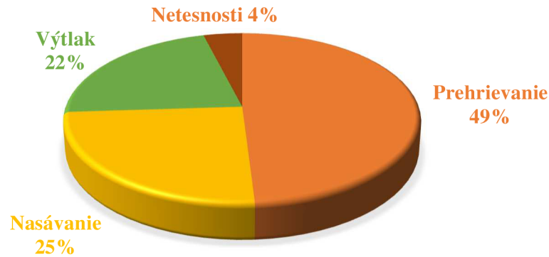
Obrázok 1.8: Podiel jednotlivých procesov na termodynamických stratách v kompresore [4].
