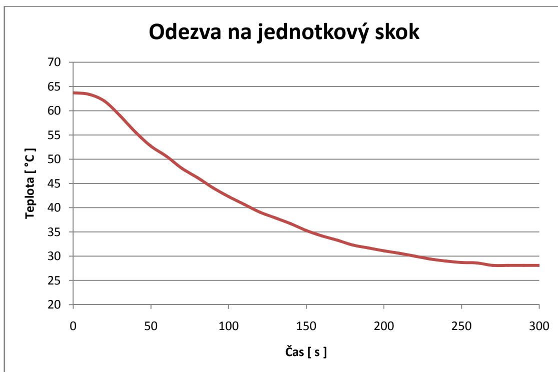
Obrázek 14.2 Odezva soustavy na jednotkový skok
