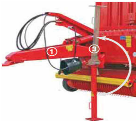
Obrázek 1 - Závěs: 1-závěs, 3-sklopná podpěra
