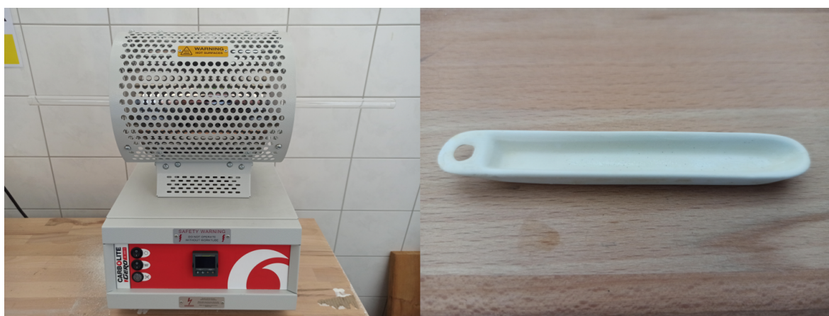
Obrázek 2.2: Trubková pec Carbolite Gero EHA 12/150B (vlevo), keramická lodička (vpravo)
