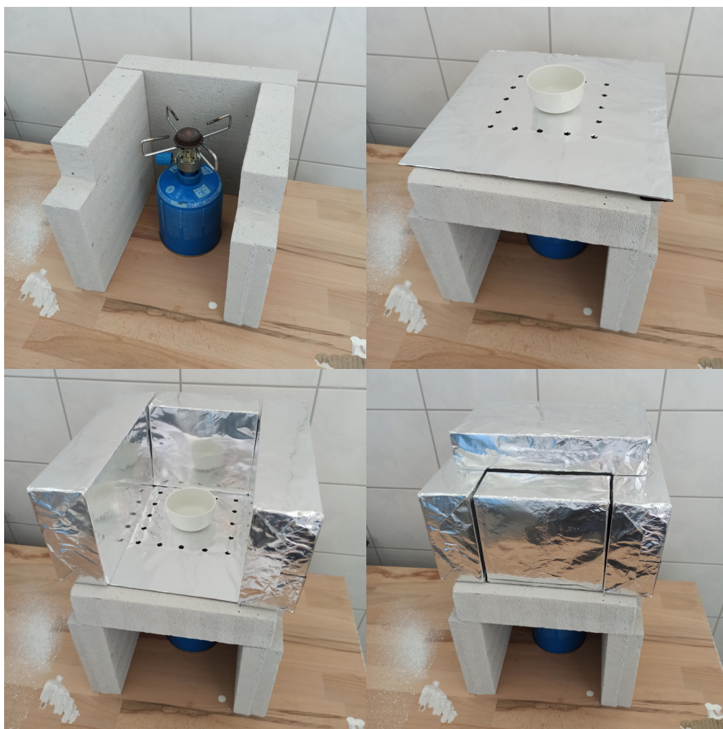
Obrázek 2.15: Sestavení plynové pece ve čtyřech krocích
