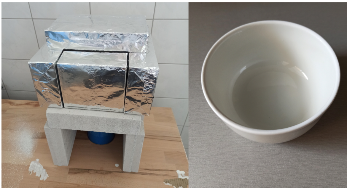
Obrázek 2.3: Plynová pec (vlevo), porcelánová žhací miska (vpravo)
