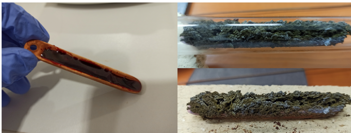
Obrázek 2.10: Vzorek 1-8-12 před vložení do pece (vlevo), uvnitř trubice po reakci v peci (vpravo nahoře), po vyjmutí z trubice (vpravo dole)
