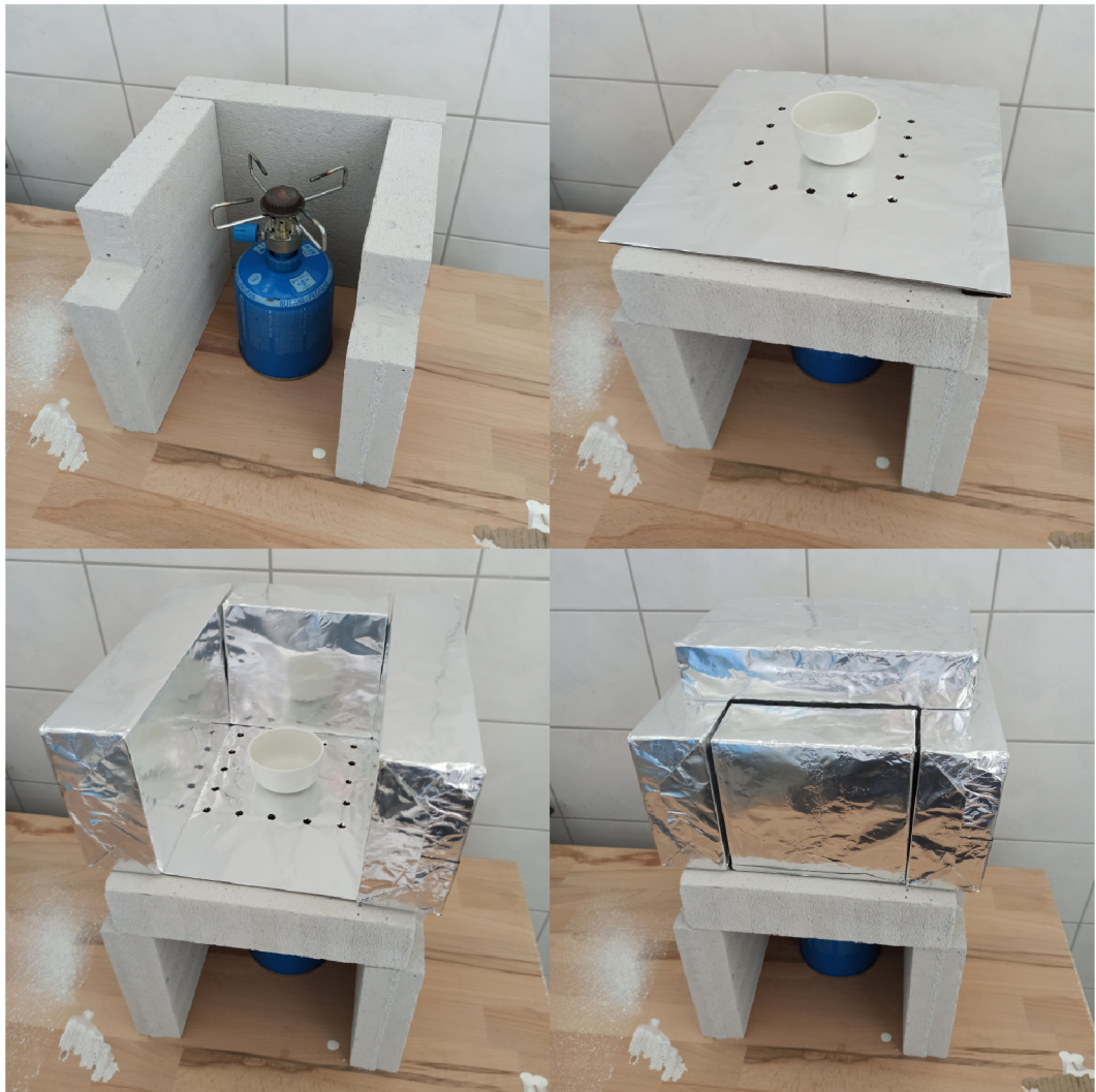
Obrázek 2.15: Sestavení plynové pece ve čtyřech krocích
