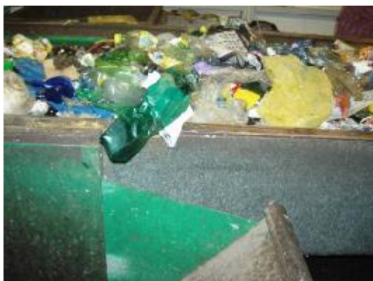
Obr. 44: Odpad na třídícím dopravníku
