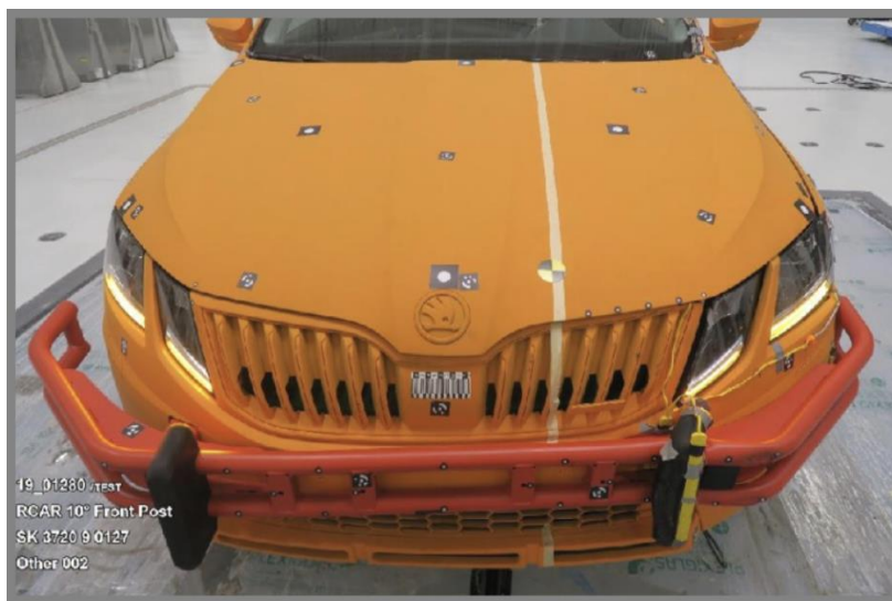
Obrázek 11 – Poškozený policejní rám po nárazu – foto Škoda Auto
