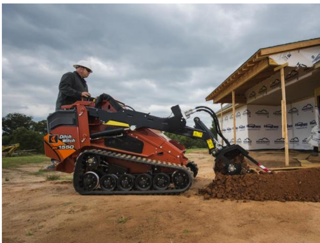
Obr. 6 Smykem řízený nakladač Ditch Witch SK 1550 [7]
