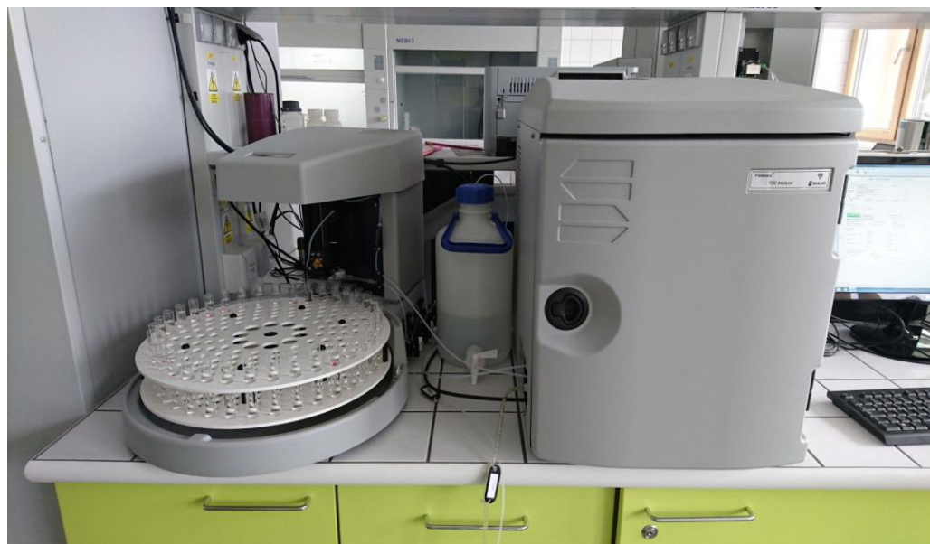
Obrázek 64: Analyzátor uhlíku a dusíku s připravenými vzorky.
