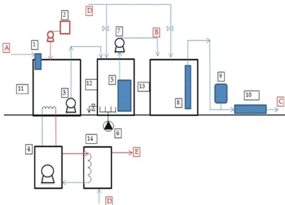
Obrázek 14: Schéma zapojení centrálního systému akumulace tepla v rámci čistírny šedých vod (Bartoník et al. 2012b). Legenda: 1) Jemné síto, 2) Dávkování NaOH, 3) Přečerpávání šedé vody do aktivační nádrže, 4) Přívod pitné vody, 5) Membránový modul, 6) Dmychadlo, 7) Čerpadlo permeátu, 8) Ponorné čerpadlo, 9) Membránová tlaková nádoba, 10) UV lampa, 11) Vyrovnávací nádrž, 12) Aktivační nádrž, 13) Akumulační nádrž, 14) Zásobník TUV, 15) Tepelný výměník, A) Šedá voda, B) Permeát, C) Vycištěná šedá voda do spotřebiště, D) Pitná voda, E) Teplá užitková voda (TUV).
