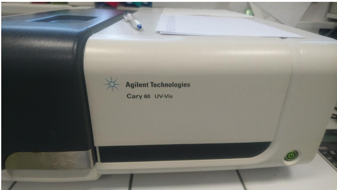
Obrázek 66: Použitý spektrofotometr pro stanovení anionaktivních tenzidů.
