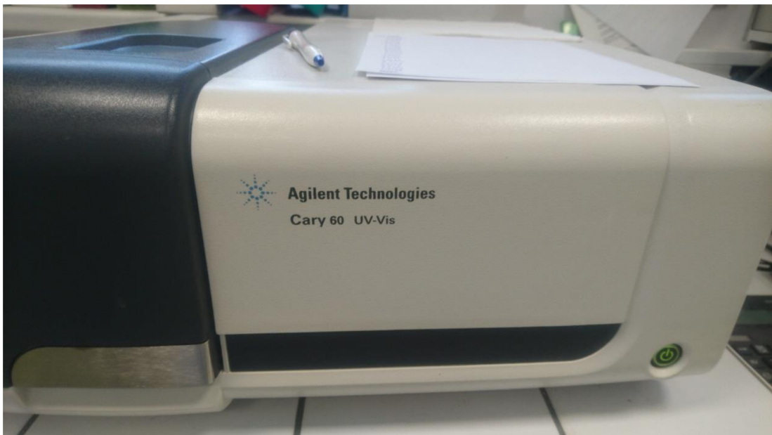
Obrázek 66: Použitý spektrofotometr pro stanovení anionaktivních tenzidů.
