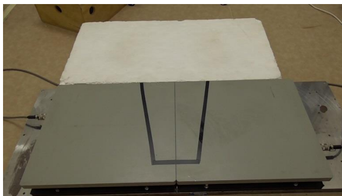
Obrázek 5. Silové plošiny AMTI doplněné o polystyrenovou desku
