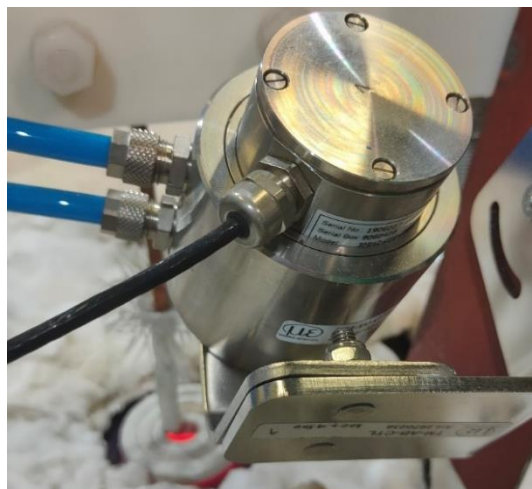
Obr. 11 Uložení pyrometru vůči induktoru a desce
