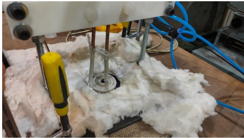
Obr. 10 Zobrazení izolace na povrchu desky v průběhu experimentu
