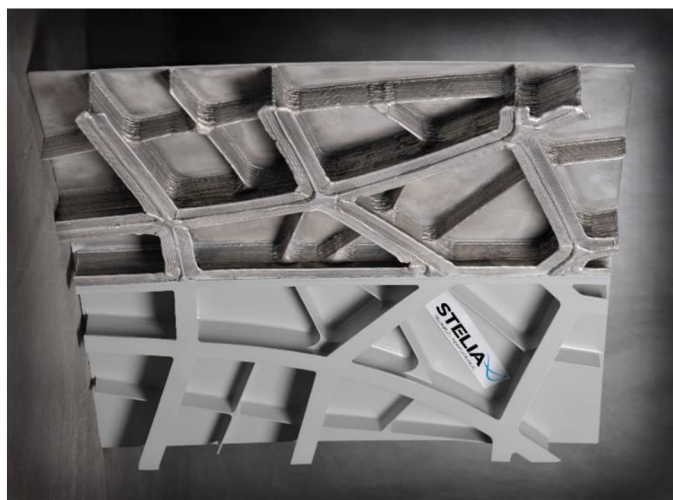
obr. 11: Svařovaný profil (WAAM) firmy Stelia Aerospace [21]
