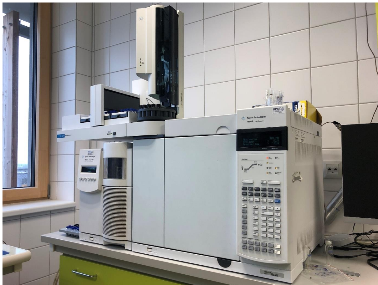
Obrázek 29 GC–MS; plynový chromatograf s hmotnostním detektorem 5975C
