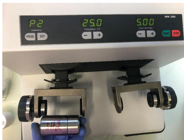
Obrázek 24 Oscilační mlýn MM 200 s nastaveným programem
