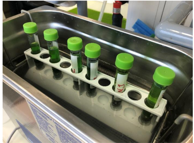
Obrázek 26 Vzorky v ultrazvukové lázni na dobu 30 minut
