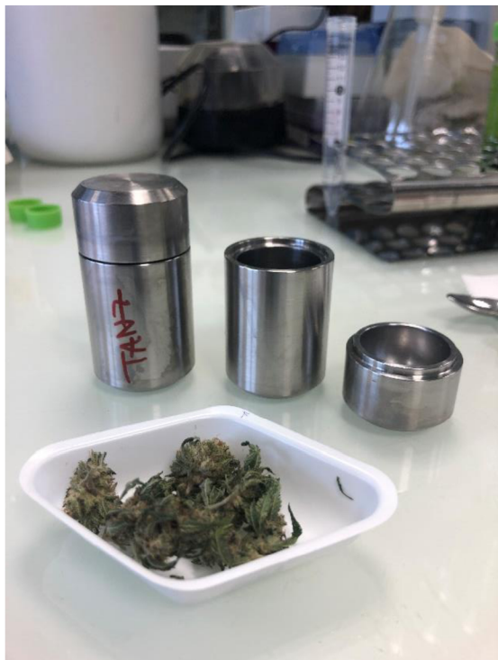
Obrázek 23 Mlecí nádoby a připravený navážený vzorek sušeného květenství
