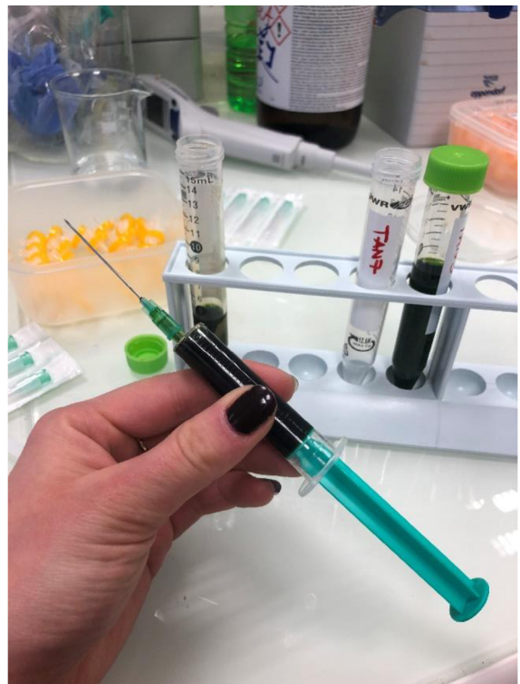
Obrázek 28 Odebírání vzorku a následné přefiltrování do vialek
