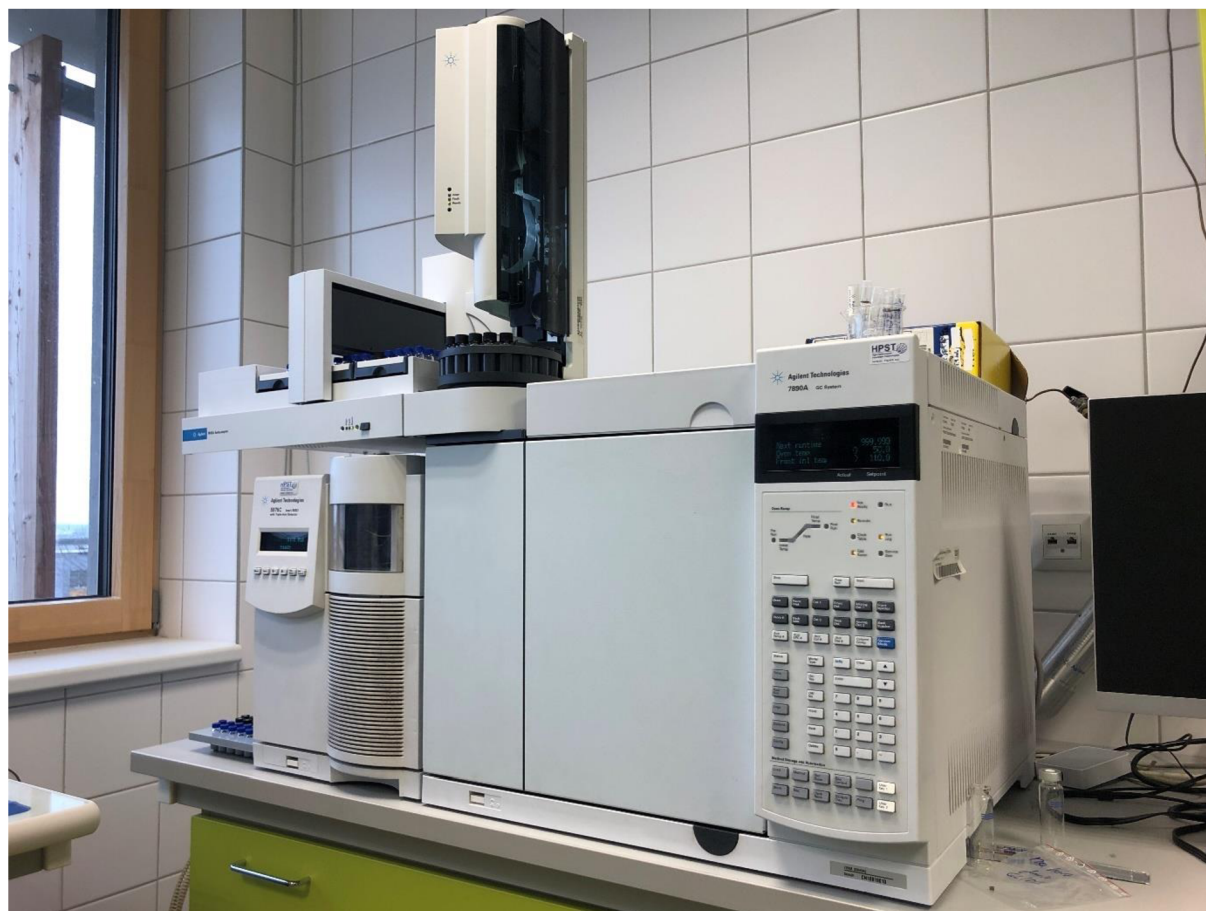
Obrázek 29 GC–MS; plynový chromatograf s hmotnostním detektorem 5975C
