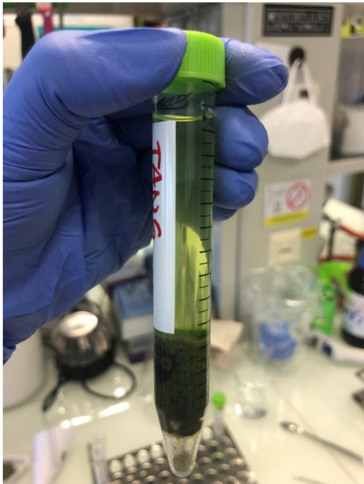
Obrázek 25 Přespaný namletý vzorek zalitý rozpouštědlem
