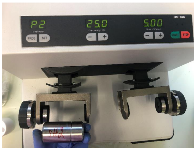
Obrázek 24 Oscilační mlýn MM 200 s nastaveným programem
