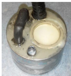
Obr. 51: Piezoelektrický rezonátor RESUN - Mist maker MM-01
