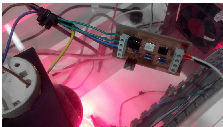
Obr. 36: Testování zkonstruovaného pohonu žárovky s detekcí nuly.
