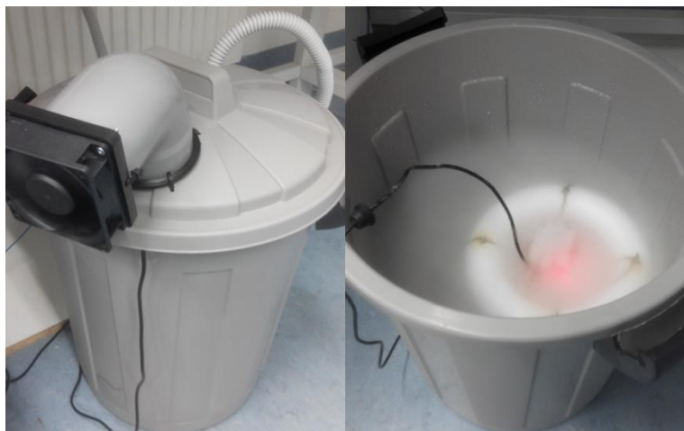
Obr. 52: Nádrž s vodou a ventilačním systémem vlevo, rezonátor upevněný na plováku vpravo.
