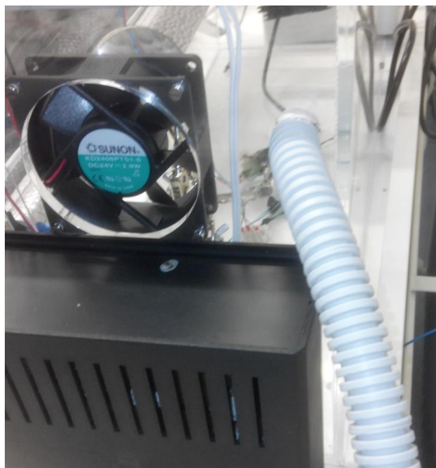
Obr. 65: Přívodní trubice pro regulaci vlhkosti.
