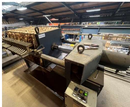
Obr. 17. Fotografie automatizovaného kalolisu
