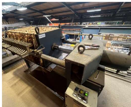
Obr. 17. Fotografie automatizovaného kalolisu
