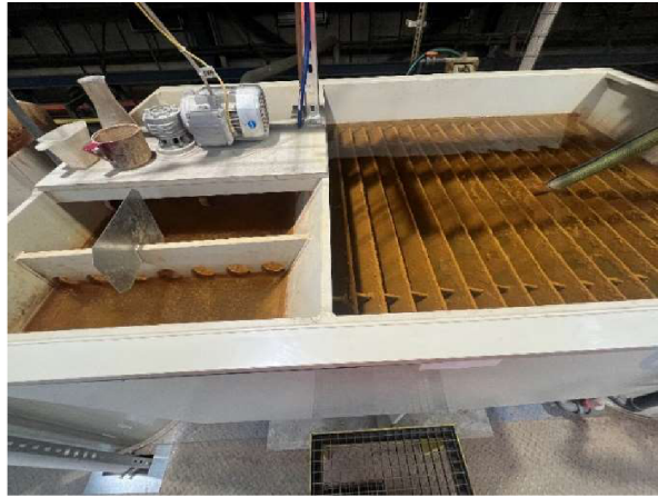
Obr. 16. Fotografie flokulační komory
