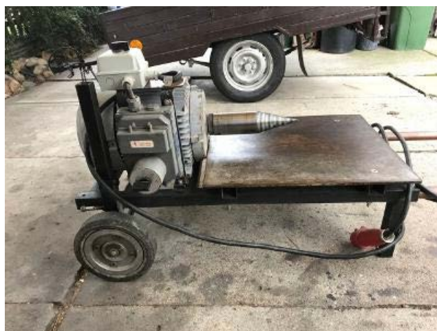
Obr. 5 Domácí kuželová štípačka dřeva [6]
