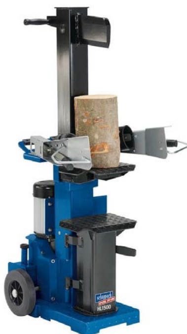
Obr. 9 Hydraulický štípač Scheppach HL 1500 [11]
