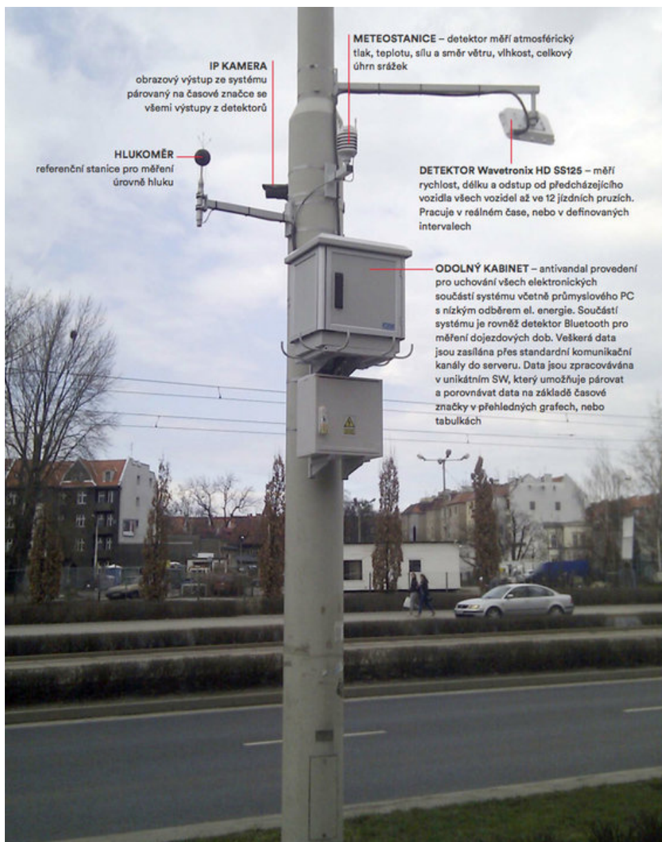
Obrázek 3 - Sloup osazený detektory projektu SMARTNET (Bárta, a další, 2016)
