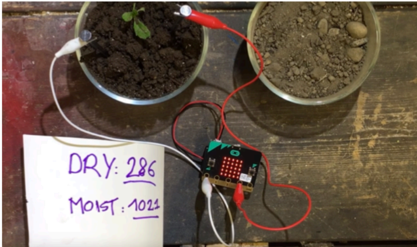
Obrázek 10 - Projekt s Micro:bit, kde byl využit pro měření vlhkosti půdy – převzato z The BBC micro:bit-From the UK to the World, 2020
