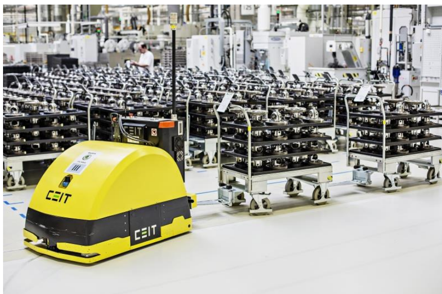
Obrázek 1 - Bepilotní transportní vozík v továrně Škoda Auto
