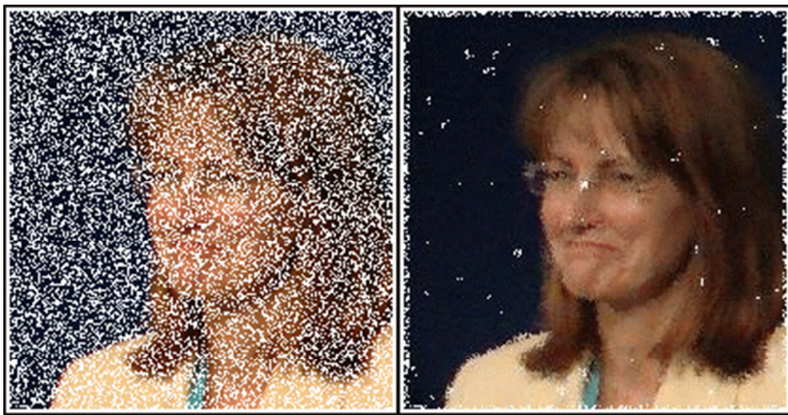
Obrázek 7 - Příklad použití mediánového filtru [27]
