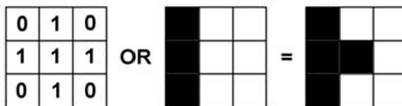
Obrázek 8 - Postup filtrování obrazu dilatací [30]
