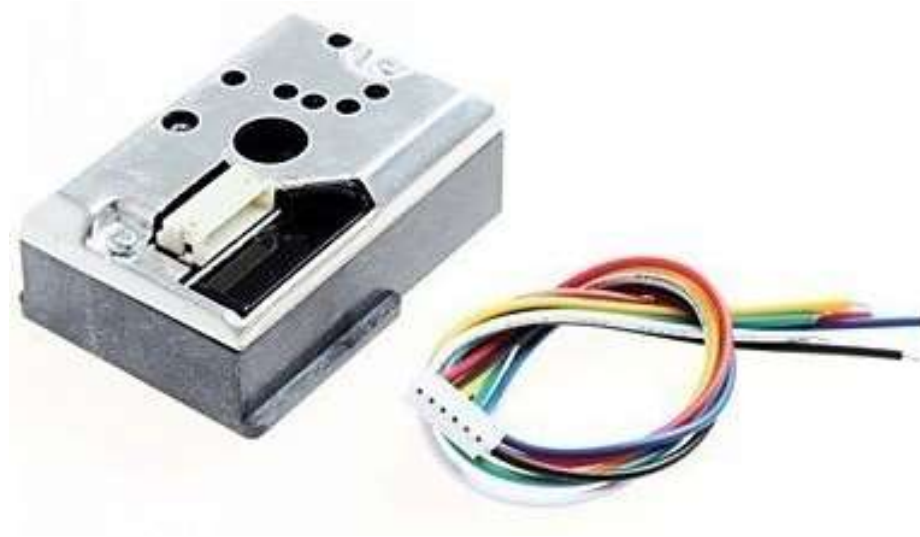
Obrázek 12 - Optický senzor množství prachu 15
