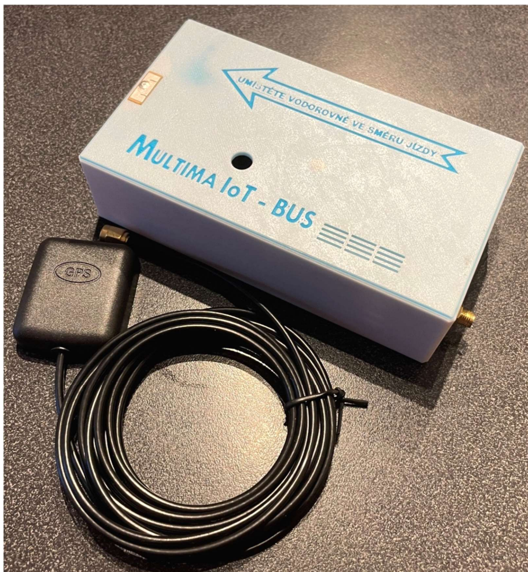
Obrázek 16 - Výsledné IoT zařízení s externí GPS anténou
