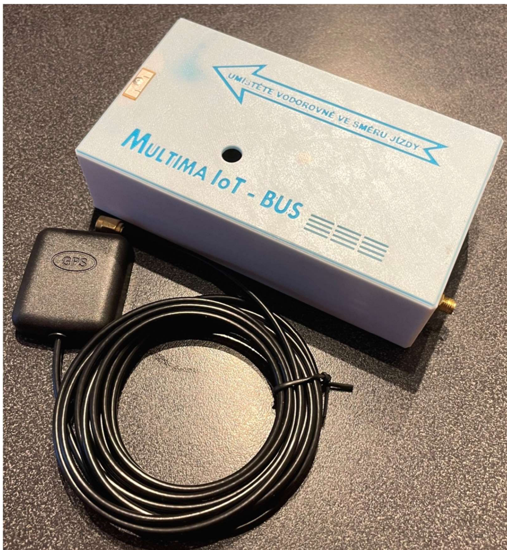
Obrázek 16 - Výsledné IoT zařízení s externí GPS anténou
