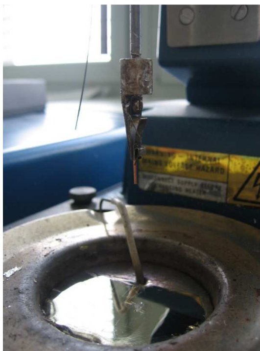
Obrázek 12: Vzorek před ponořením do roztavené pájky
