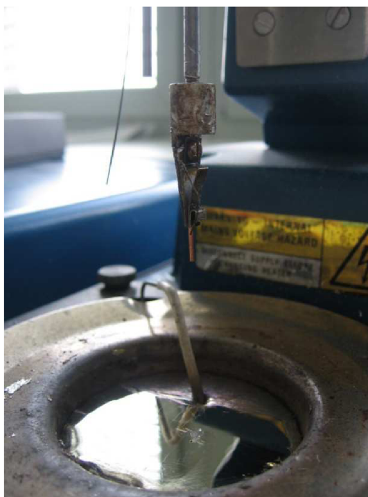
Obrázek 12: Vzorek před ponořením do roztavené pájky
