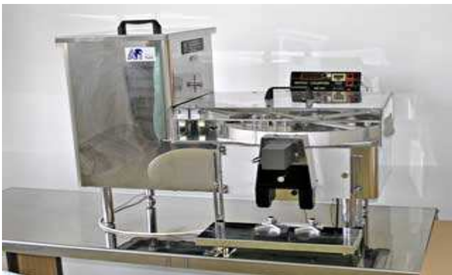
Obrázek 7 – Stroj na rozplňování tablet a kapslí do dóz
