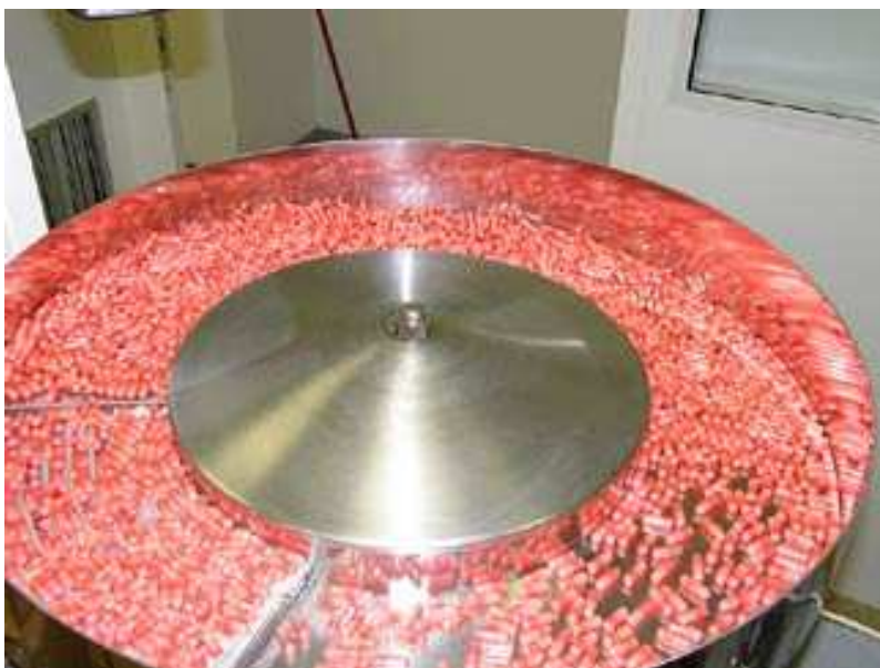
Obrázek 3 – Blistrovací stroj – vibrační talíř k plnicím drahám
