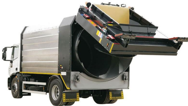
Obr. 3.4 Nadstavba vozidla s rotačným lisom [19]
