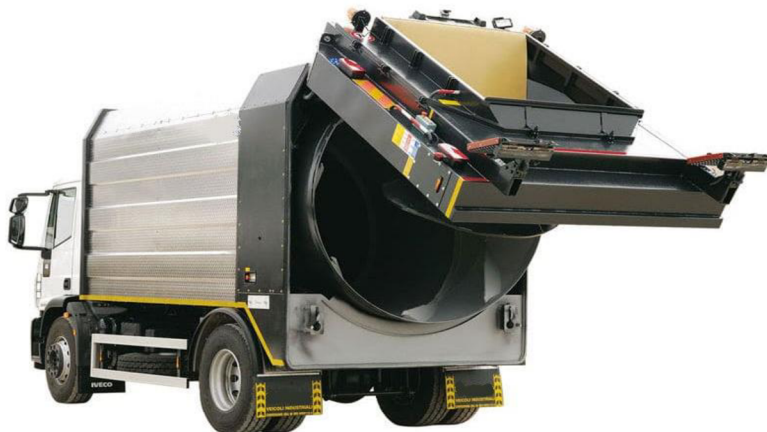
Obr. 3.4 Nadstavba vozidla s rotačným lisom [19]
