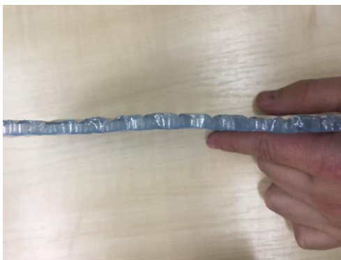
Obr. 4 Typický příklad reflexní izolace typu 1, bublinková folie [autor]
