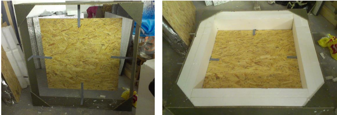
Obr. 7 Ukázka z realizace typického zkušebního prvku pro měření tepelného odporu izolované vzduchové dutiny [autor]
