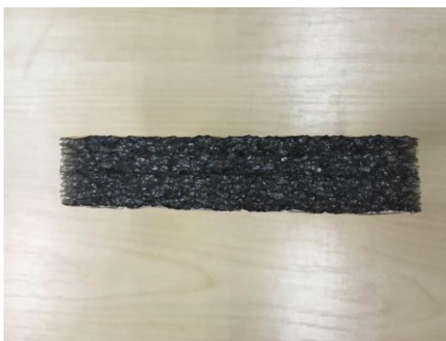
Obr. 2 Typický příklad reflexní izolace typu 1, jádro z pěnového polyetylénu [autor]
